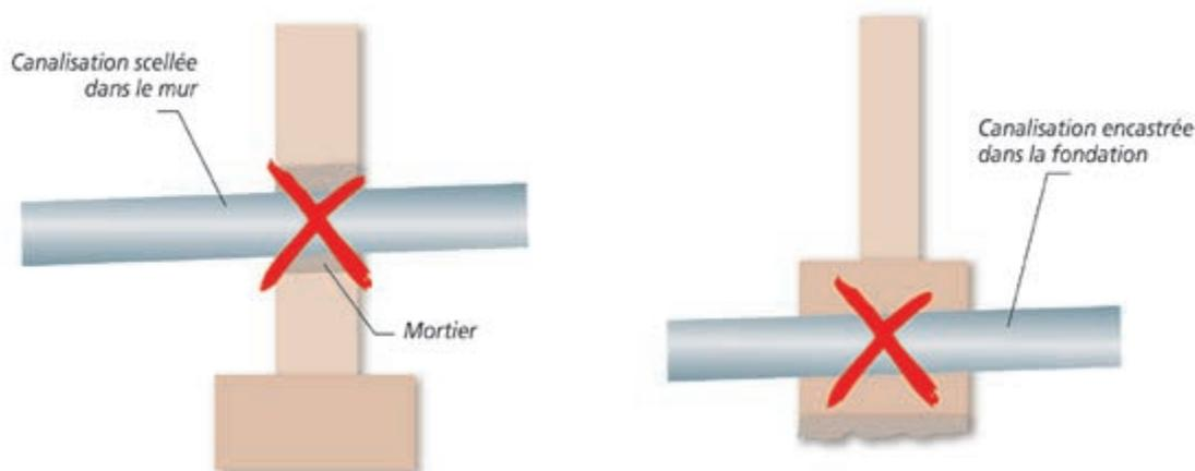
**Conditions de mise en œuvre :** Les canalisations seront réalisées avec des matériaux non fragiles (c'est-à-dire susceptibles de subir des déformations sans rupture). Elles seront aussi flexibles que possibles, de façon à supporter sans dommage les mouvements du sol.
